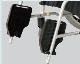
フットサポートは跳ね上げることができ、乗降時に邪魔にならないようにしたり、折りたたみの際にコンパクトにすることができます。
