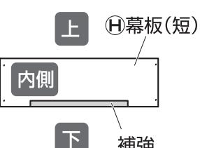
2.幕板を本体にかぶせ、⑩幕板(長)側から⑪木ネジ(短)で仮留めします。(計8カ所)
