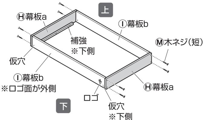
2. 幕板を本体にかぶせ、①幕板b側から②木ネジ(短)で仮留めします。(計4カ所)
